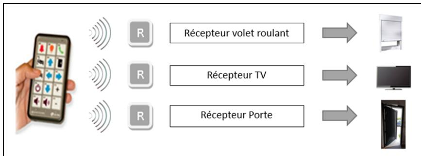
Pour une installation avec peu de fonctionnalités, il est possible de brancher des récepteurs IR ou radio sur le courant porteur.
